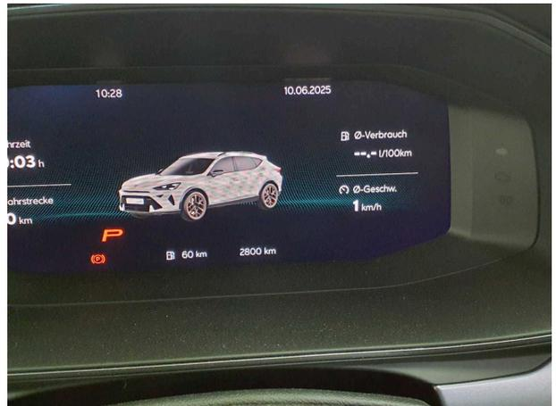
**Abbildung 10: Kombiinstrument**
