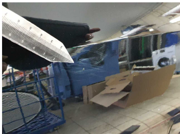
Beschädigung #4: Tür hinten rechts: Tür (Oberflächliche) - Kratzer
