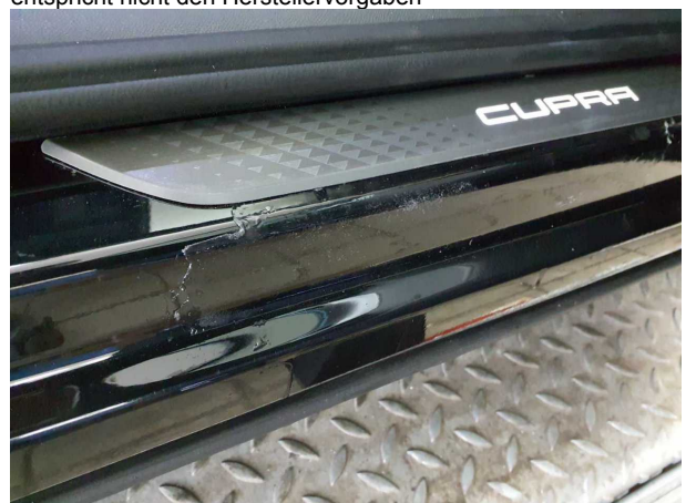
Beschädigung #3: Schweller rechts: Einstieg (Klebereste) - entspricht nicht den Herstellervorgaben
