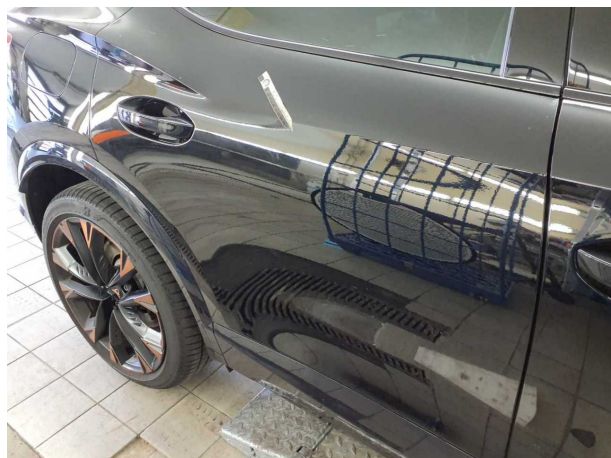
Beschädigung #4: Tür hinten rechts: Tür (Oberflächliche) - Kratzer
