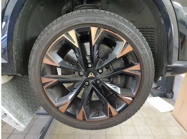
Beschädigung #1: Rad/Reifen: Leichtmetallfelge vorn rechts - Kratzer
