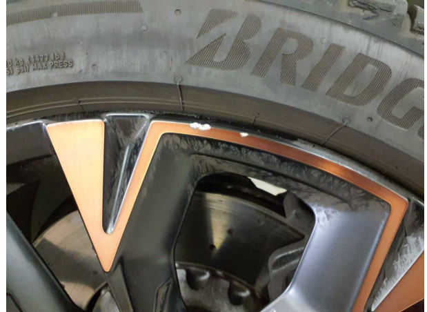
Beschädigung #1: Rad/Reifen: Leichtmetallfelge vorn rechts - Kratzer
