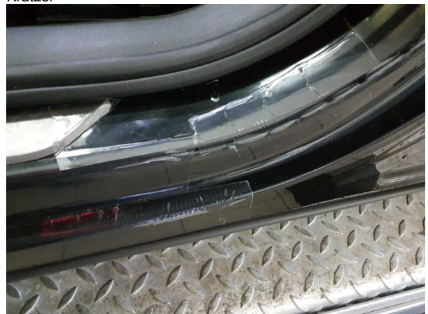
Beschädigung #2: Schweller links: Einstieg (Klebereste) - entspricht nicht den Herstellervorgaben
