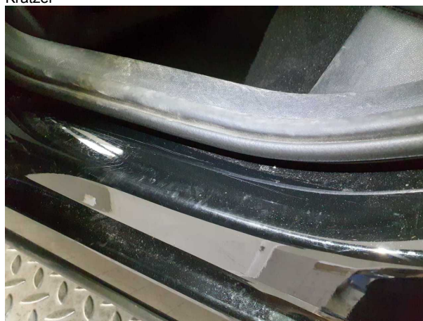
Beschädigung #7: Seitenwand links: Einstieg - Kratzer
