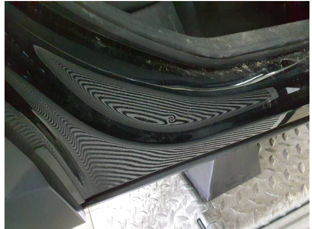
Beschädigung #8: Seitenwand rechts: Einstieg - Delle / Lackschaden
