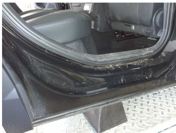
Beschädigung #8: Seitenwand rechts: Einstieg - Delle / Lackschaden
