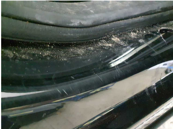
Beschädigung #8: Seitenwand rechts: Einstieg - Delle / Lackschaden
