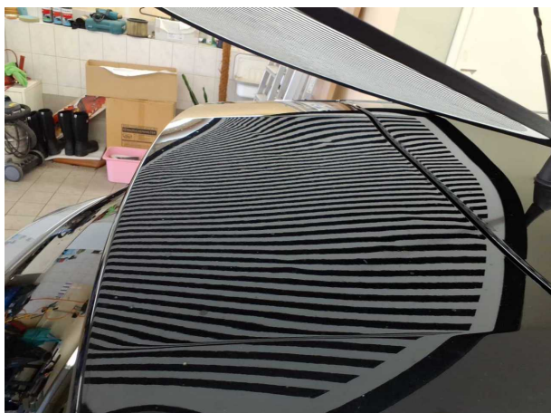
Beschädigung #2: Heckklappe/-tür: Heckklappe (Ca.12 Dellen) - Delle(n)
