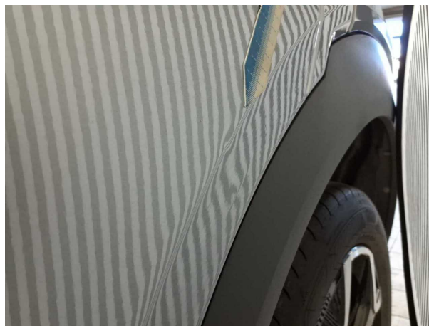
Beschädigung #3: Tür hinten links: Tür - Delle(n)
