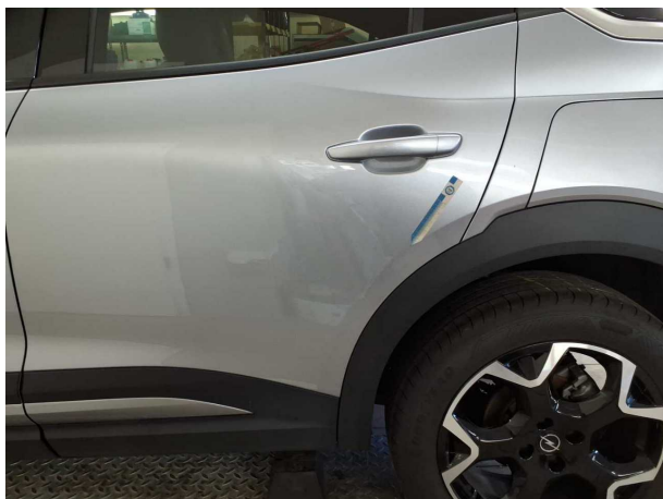
Beschädigung #3: Tür hinten links: Tür - Delle(n)
