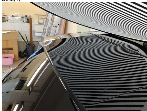
Beschädigung #2: Heckklappe/-tür: Heckklappe (Ca.12 Dellen) - Delle(n)
