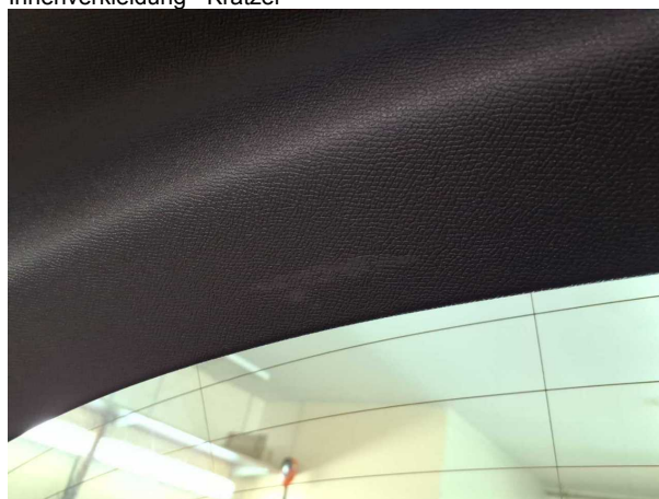
Beschädigung #2: Verkleidungen/Abdeckungen: Heckdeckel, Innenverkleidung - Kratzer
