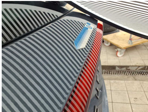
Beschädigung #1: Heckklappe/-tür: Heckklappe - Delle(n)
