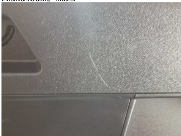
Beschädigung #2: Verkleidungen/Abdeckungen: Heckdeckel, Innenverkleidung - Kratzer
