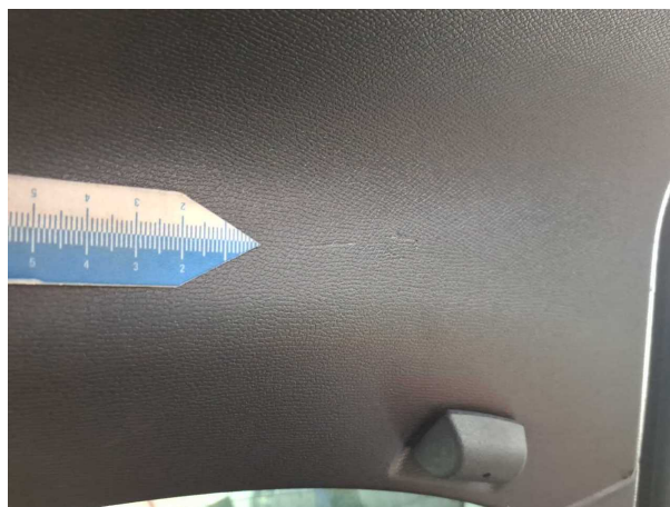
Beschädigung #2: Verkleidungen/Abdeckungen: Heckdeckel, Innenverkleidung - Kratzer
