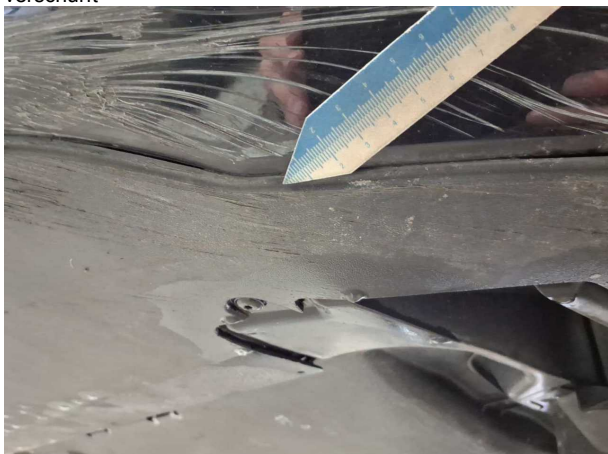
Beschädigung #3: Karosserie: Unterbodenverkleidung - verkratzt / verschürft
