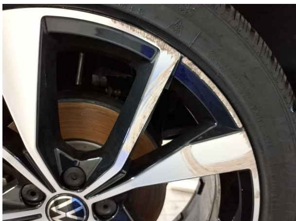
Beschädigung #5: Rad/Reifen: Leichtmetallfelge vorn links - verkratzt / verschürft
