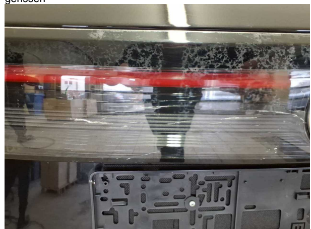
Beschädigung #2: Heckleuchte: Heckleuchte - gebrochen / gerissen
