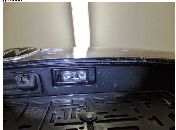
Beschädigung #2: Heckleuchte: Heckleuchte - gebrochen / gerissen
