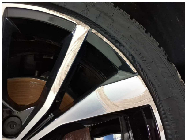
Beschädigung #5: Rad/Reifen: Leichtmetallfelge vorn links - verkratzt / verschürft
