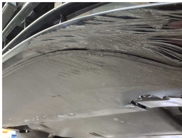
Beschädigung #3: Karosserie: Unterbodenverkleidung - verkratzt / verschürft
