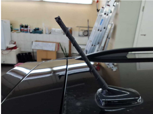
Beschädigung #1: Fahrzeugdach: Antennenstab - gebrochen / gerissen
