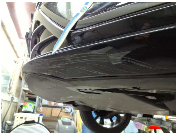
Beschädigung #6: Stossfänger vorn: Stossfänger vorn - verkratzt / verschürft
