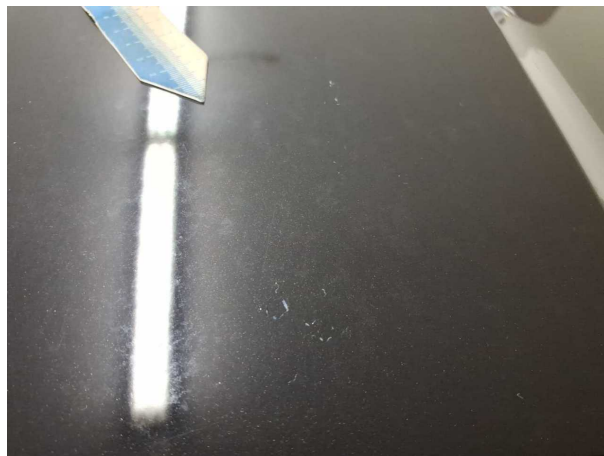
Beschädigung #4: Motorhaube: Motorhaube - Lackmangel
