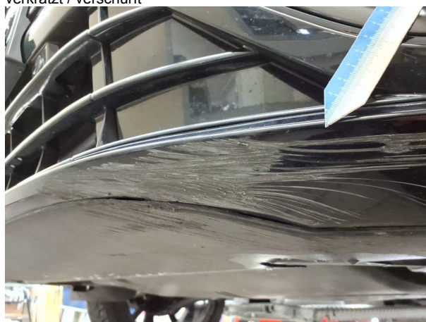
Beschädigung #6: Stossfänger vorn: Stossfänger vorn - verkratzt / verschürft
