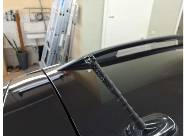
Beschädigung #1: Fahrzeugdach: Antennenstab - gebrochen / gerissen
