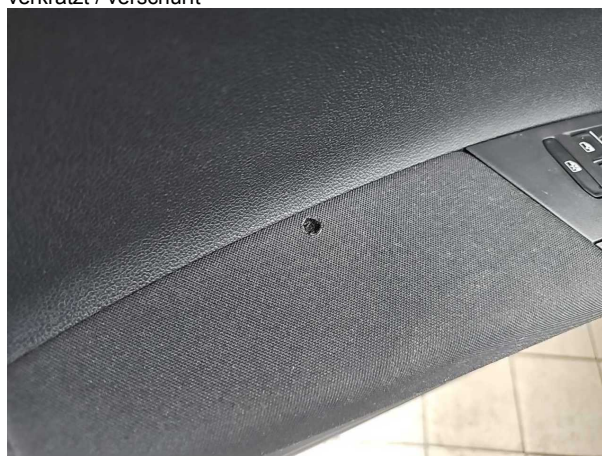
Beschädigung #2: Verkleidungen/Abdeckungen: Türverkleidung vorn links - Brandloch
