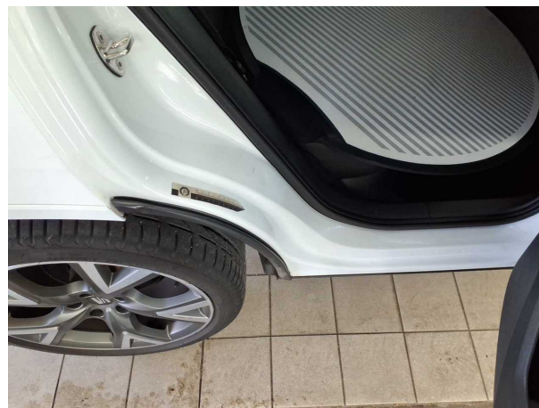
Beschädigung #10: Seitenwand rechts: Einstieg - Delle / Lackschaden
