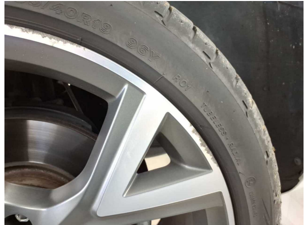
Beschädigung #7: Rad/Reifen: Leichtmetallfelge vorn rechts - verkratzt / verschürft
