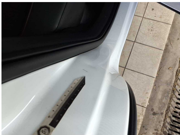
Beschädigung #10: Seitenwand rechts: Einstieg - Delle / Lackschaden
