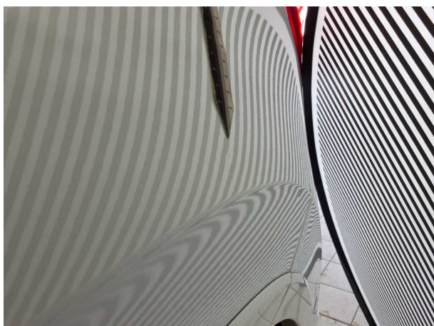
Beschädigung #9: Seitenwand links: Seitenwand (2 Dellen) - Delle(n)
