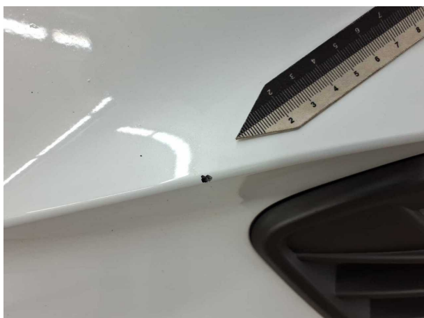
Beschädigung #14: Stossfänger vorn: Stossfänger vorn links - Kratzer
