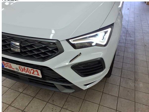
Beschädigung #14: Stossfänger vorn: Stossfänger vorn links - Kratzer
