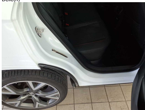
Beschädigung #10: Seitenwand rechts: Einstieg - Delle / Lackschaden
