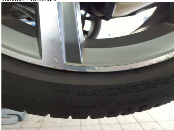
Beschädigung #4: Rad/Reifen: Leichtmetallfelge hinten links - verkratzt / verschürft
