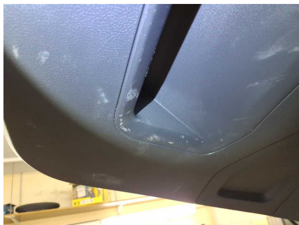
Beschädigung #3: Heckklappe/-tür: Verkleidung Standard unten - verkratzt / verschürft
