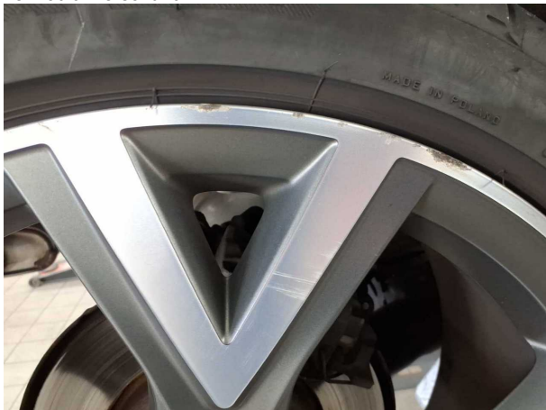
Beschädigung #5: Rad/Reifen: Leichtmetallfelge hinten rechts - verkratzt / verschürft
