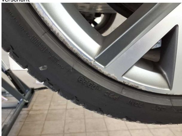
Beschädigung #7: Rad/Reifen: Leichtmetallfelge vorn rechts - verkratzt / verschürft
