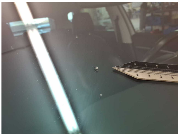
Beschädigung #15: Verglasung: Frontscheibe - Steinschlag
