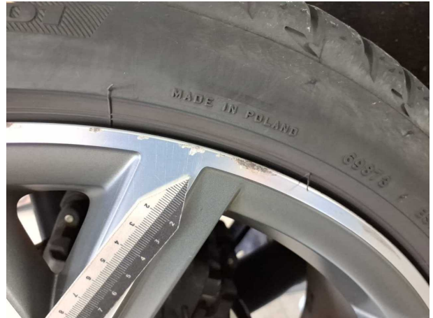
Beschädigung #5: Rad/Reifen: Leichtmetallfelge hinten rechts - verkratzt / verschürft
