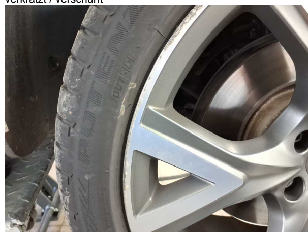
Beschädigung #7: Rad/Reifen: Leichtmetallfelge vorn rechts - verkratzt / verschürft
