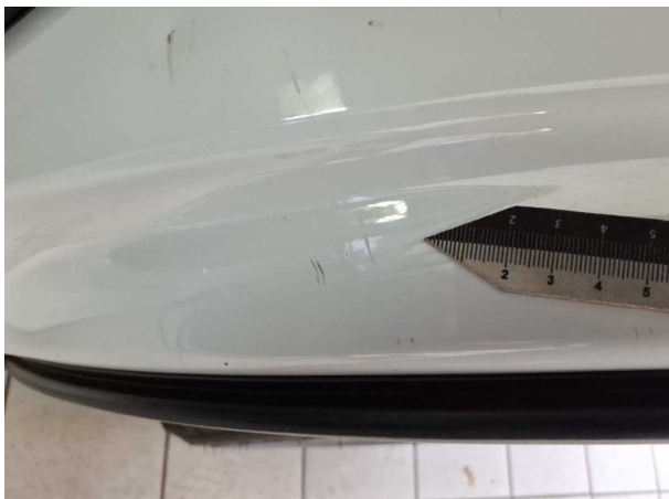
Beschädigung #8: Seitenwand links: Einstieg - Delle / Lackschaden
