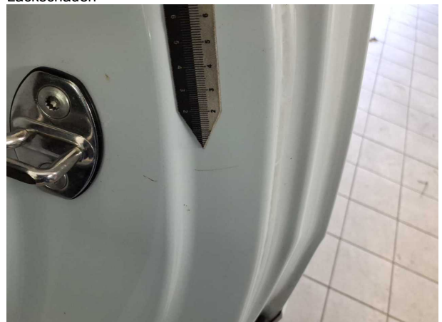
Beschädigung #8: Seitenwand links: Einstieg - Delle / Lackschaden
