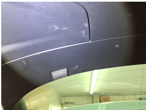
Beschädigung #3: Heckklappe/-tür: Verkleidung Standard unten - verkratzt / verschürft
