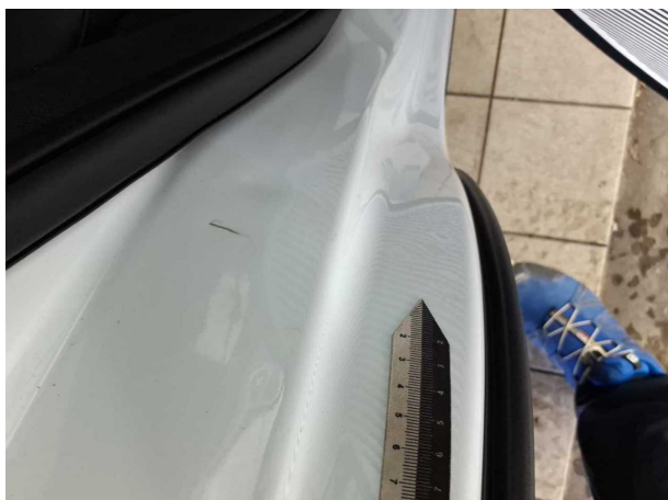
Beschädigung #10: Seitenwand rechts: Einstieg - Delle / Lackschaden
