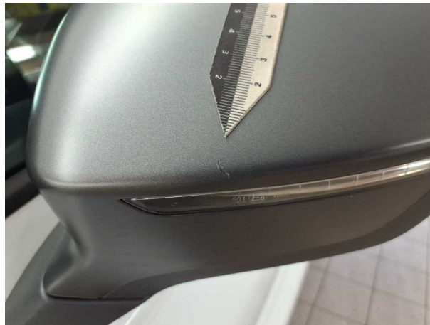
Beschädigung #1: Außenspiegel links: Abdeckkappe - Kratzer
