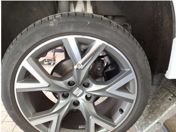
Beschädigung #5: Rad/Reifen: Leichtmetallfelge hinten rechts - verkratzt / verschürft
