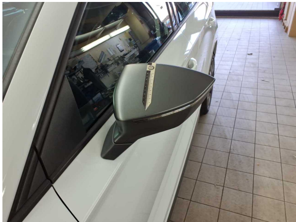
Beschädigung #1: Außenspiegel links: Abdeckkappe - Kratzer
