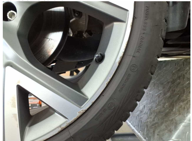
Beschädigung #5: Rad/Reifen: Leichtmetallfelge hinten rechts - verkratzt / verschürft
