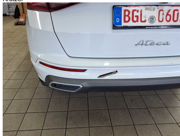
Beschädigung #13: Stossfänger hinten: Stossfänger hinten - Kratzer
