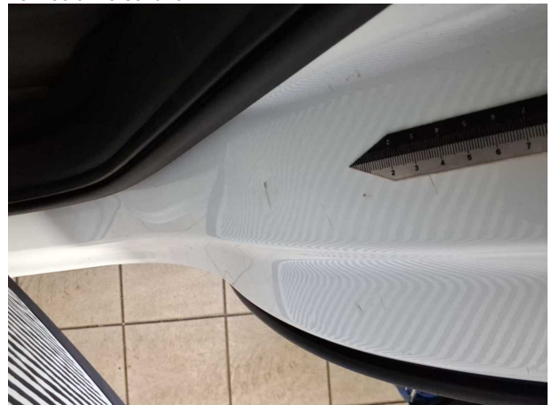
Beschädigung #8: Seitenwand links: Einstieg - Delle / Lackschaden
