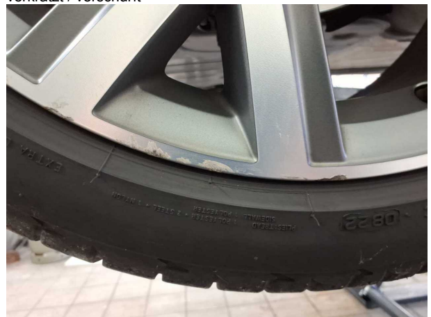
Beschädigung #6: Rad/Reifen: Leichtmetallfelge vorn links - verkratzt / verschürft
