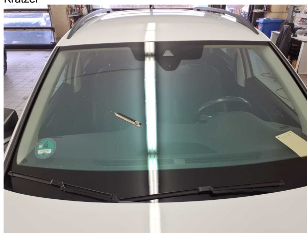
Beschädigung #15: Verglasung: Frontscheibe - Steinschlag
