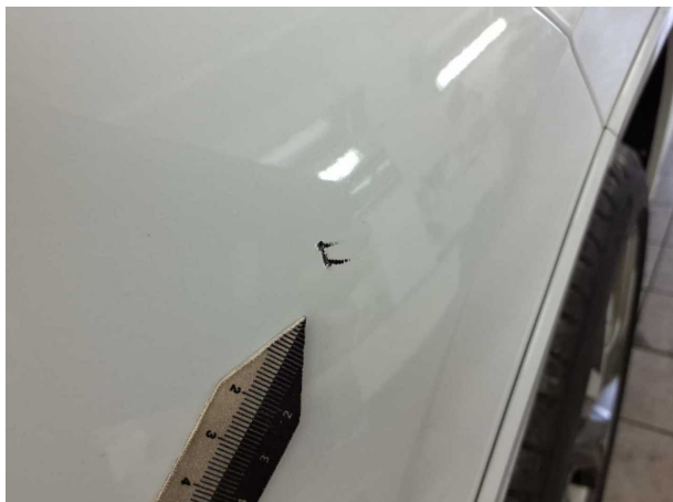
Beschädigung #14: Stossfänger vorn: Stossfänger vorn links - Kratzer
