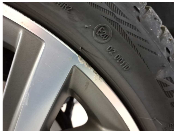
Beschädigung #6: Rad/Reifen: Leichtmetallfelge vorn links - verkratzt / verschürft
