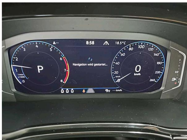
Abbildung 10: Kombiinstrument
