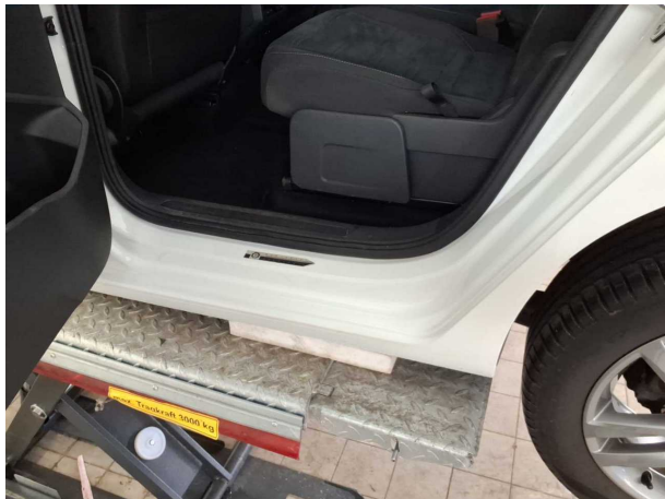
Beschädigung #1: Seitenwand links: Einstieg - Delle(n)
