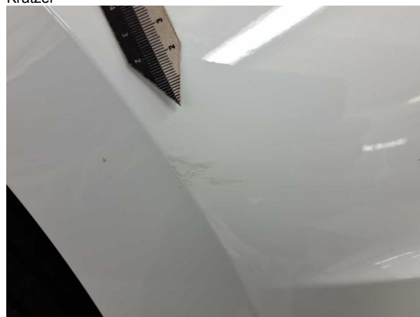
Beschädigung #3: Stossfänger vorn: Stossfänger vorn rechts - Kratzer
