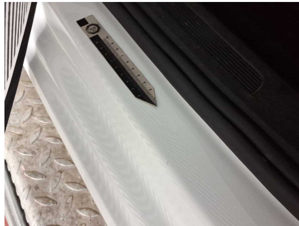
Beschädigung #1: Seitenwand links: Einstieg - Delle(n)
