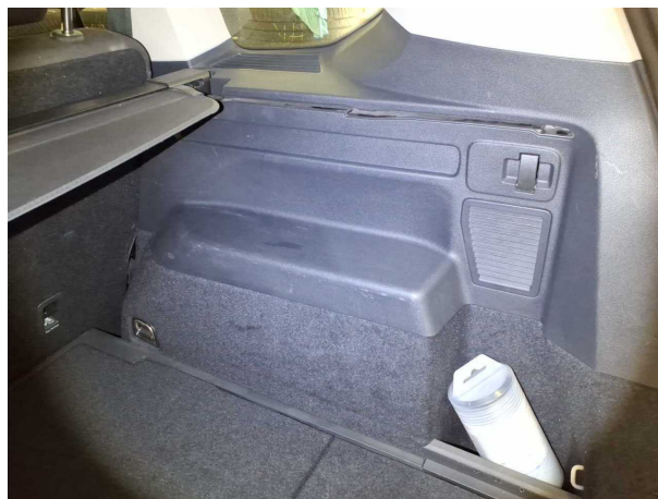
Beschädigung #8: Verkleidungen/Abdeckungen: Kofferraumverkleidung (Rechts) - verkratzt / verschürft
