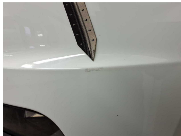
Beschädigung #2: Stossfänger vorn: Stossfänger vorn links - Kratzer
