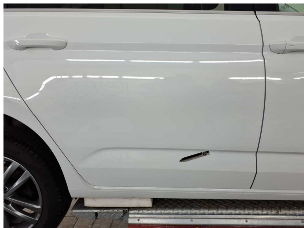
Beschädigung #4: Tür hinten rechts: Tür - verformt
