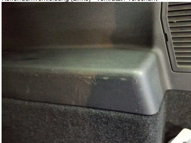
Beschädigung #8: Verkleidungen/Abdeckungen: Kofferraumverkleidung (Rechts) - verkratzt / verschürft
