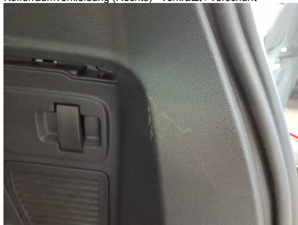
Beschädigung #8: Verkleidungen/Abdeckungen: Kofferraumverkleidung (Rechts) - verkratzt / verschürft
