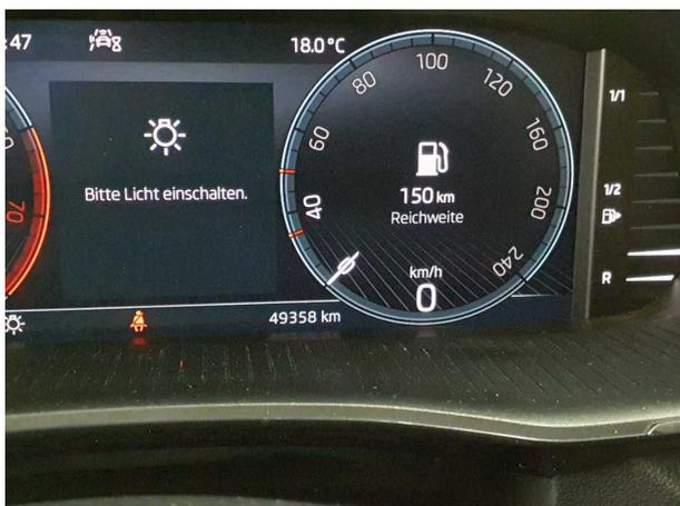
**Abbildung 11: Kombiinstrument**
