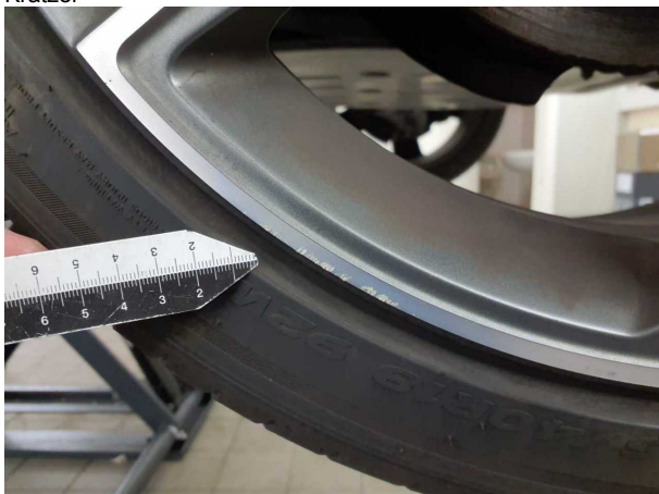
Beschädigung #2: Rad/Reifen: Leichtmetallfelge vorn rechts - Kratzer
