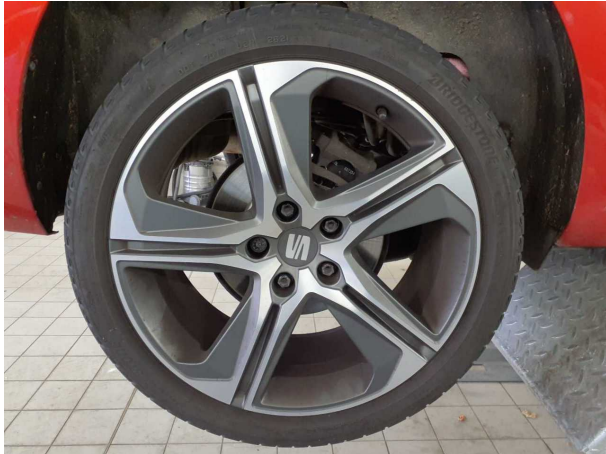
Beschädigung #1: Rad/Reifen: Leichtmetallfelge hinten rechts - Kratzer
