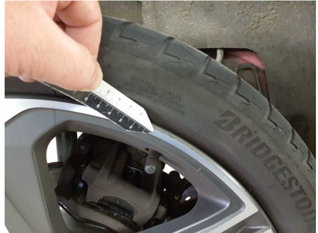
Beschädigung #1: Rad/Reifen: Leichtmetallfelge hinten rechts - Kratzer
