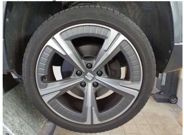
Beschädigung #5: Rad/Reifen: Leichtmetallfelge vorn rechts - Kratzer
