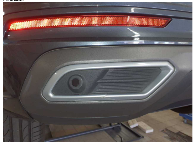
Beschädigung #6: Stossfänger hinten: Spoiler - gebrochen / gerissen
