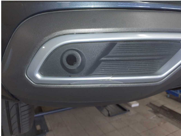
Beschädigung #6: Stossfänger hinten: Spoiler - gebrochen / gerissen
