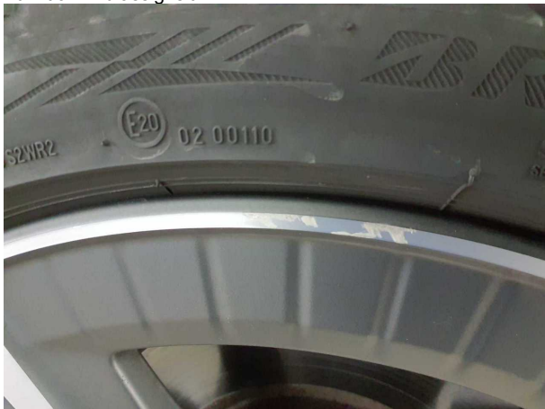
Beschädigung #5: Rad/Reifen: Leichtmetallfelge vorn rechts - Kratzer
