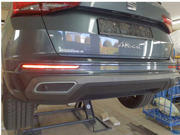
Beschädigung #6: Stossfänger hinten: Spoiler - gebrochen / gerissen
