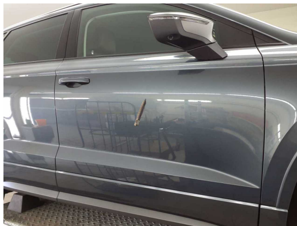
Beschädigung #9: Tür vorn rechts: Tür (2) - Delle(n) - sanft instandsetzen
