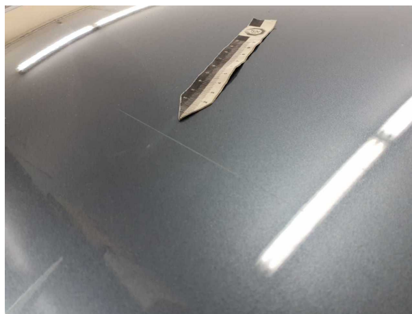
Beschädigung #3: Motorhaube: Motorhaube - Kratzer
