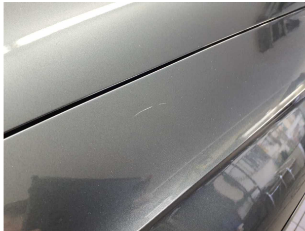
Beschädigung #1: Kotflügel links: Kotflügel links - Kratzer
