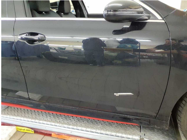
Beschädigung #1: Tür vorn rechts: Tür - Delle / Lackschaden
