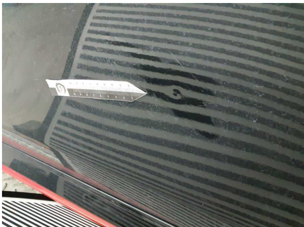
Beschädigung #1: Tür vorn rechts: Tür - Delle / Lackschaden
