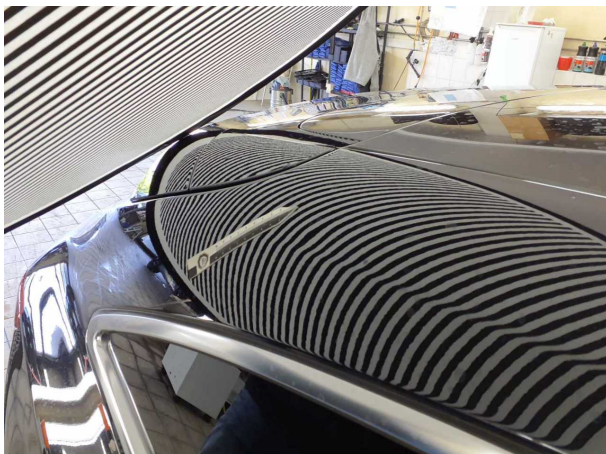
Beschädigung #2: Fahrzeugdach: Dachholm rechts (1 Delle) - Delle(n)
