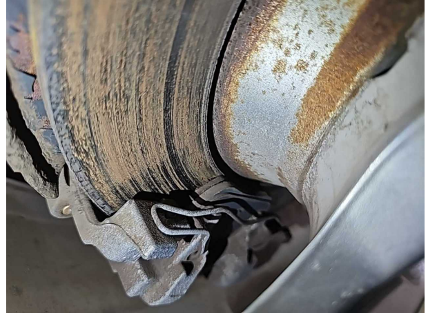
Beschädigung #1: Bremsanlage: Bremsscheiben und Beläge hinten - Korrosion
