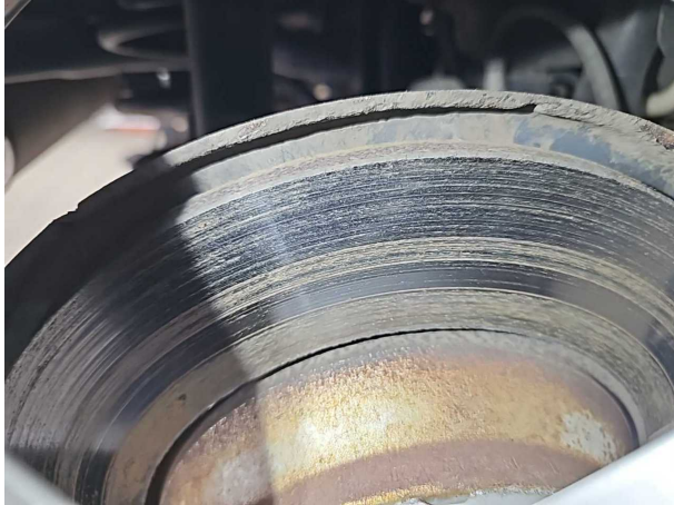
Beschädigung #1: Bremsanlage: Bremsscheiben und Beläge hinten - Korrosion
