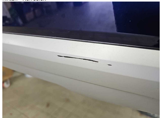
Beschädigung #2: Stossfänger hinten: Spoiler - verkratzt / verschürft
