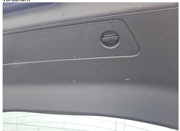
Beschädigung #3: Verkleidungen/Abdeckungen: Heckdeckel, Innenverkleidung - verkratzt / verschürft
