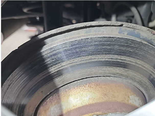
Beschädigung #1: Bremsanlage: Bremsscheiben und Beläge hinten - Korrosion
