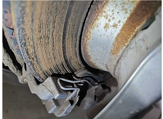
Beschädigung #1: Bremsanlage: Bremsscheiben und Beläge hinten - Korrosion
