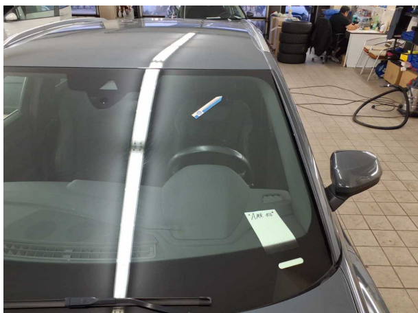
Beschädigung #19: Verglasung: Frontscheibe (3 Steinschläge im Sichtbereich) - Steinschlag
