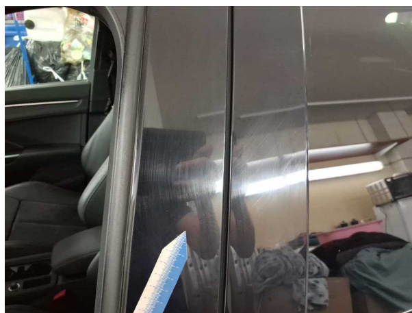
Beschädigung #17: Tür vorn links: Zierleiste oben - verkratzt / verschürft
