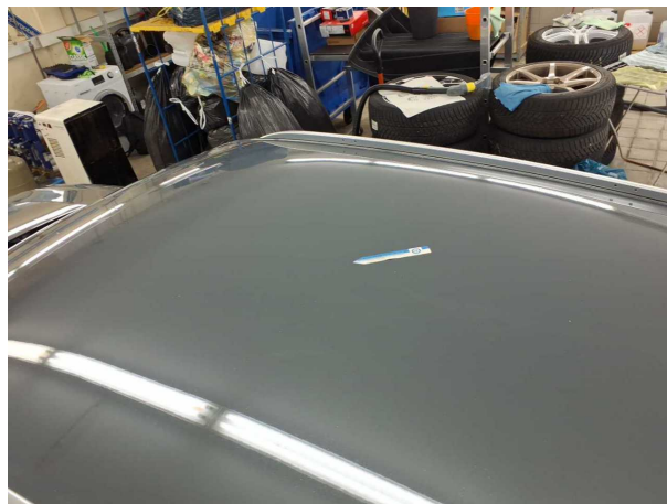
Beschädigung #2: Fahrzeugdach: Dach - Delle(n)
