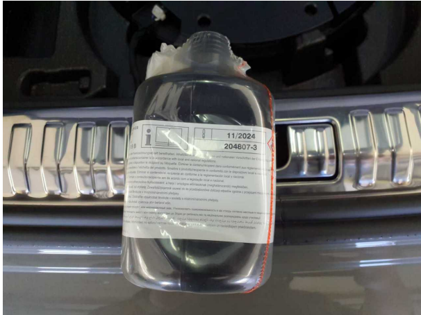
Beschädigung #1: Ausrüstung: Tirefit Füllmittel - abgelaufen
