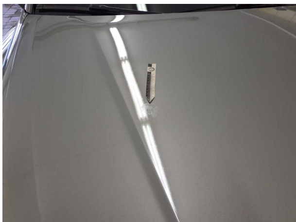
Beschädigung #5: Motorhaube: Motorhaube - Lackmangel
