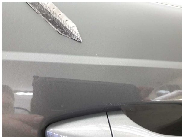
Beschädigung #7: Tür vorn rechts: Tür - Kratzer
