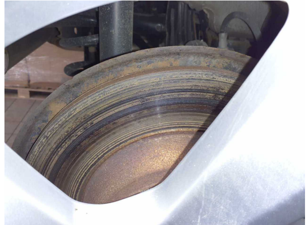
Beschädigung #2: Bremsanlage: Bremsscheiben hinten - Korrosion
