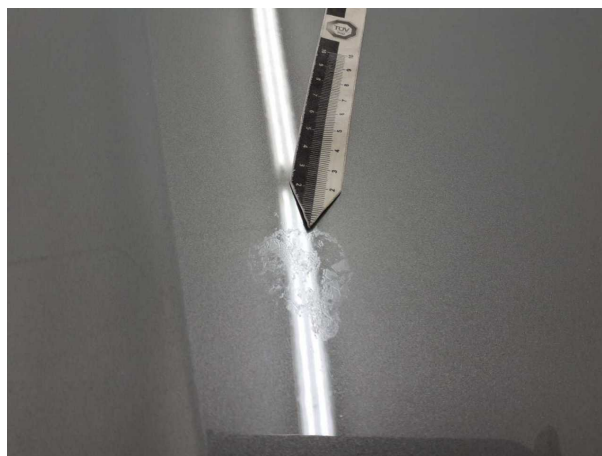
Beschädigung #5: Motorhaube: Motorhaube - Lackmangel
