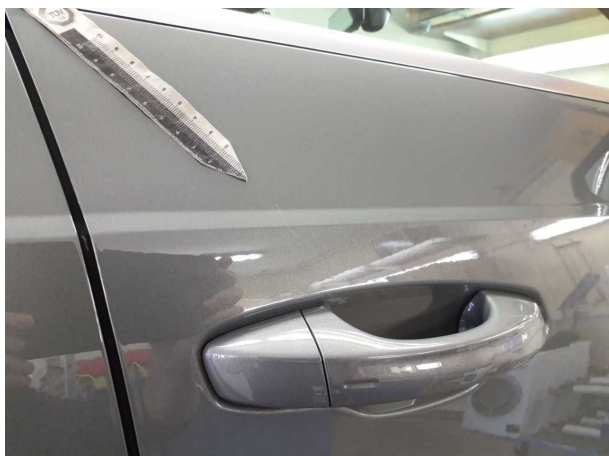
Beschädigung #7: Tür vorn rechts: Tür - Kratzer
