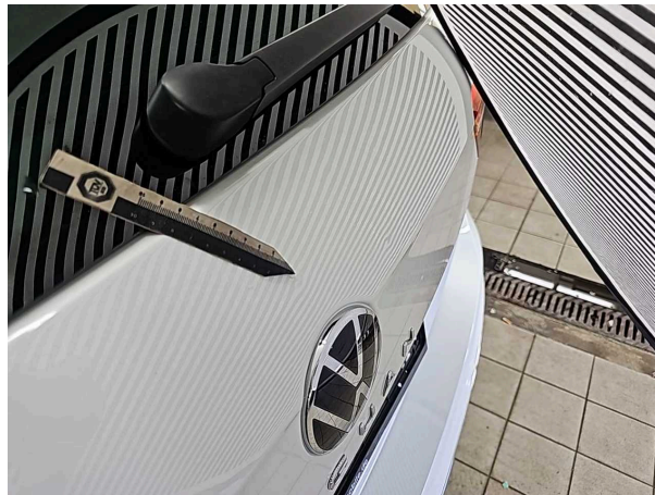
Beschädigung #1: Heckklappe/-tür: Heckklappe - Delle(n)
