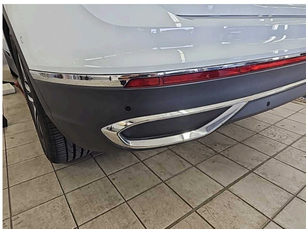
Beschädigung #2: Stossfänger hinten: Schutzleiste links - gebrochen / gerissen
