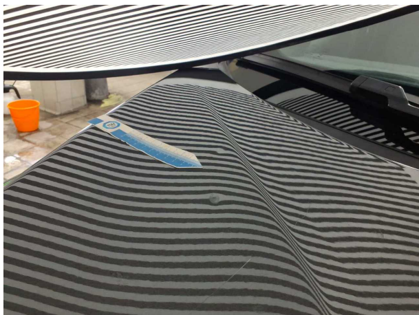
Beschädigung #6: Motorhaube: Motorhaube (Dellen) - Kratzer
