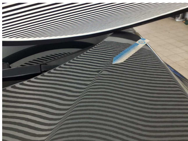
Beschädigung #6: Motorhaube: Motorhaube (Dellen) - Kratzer
