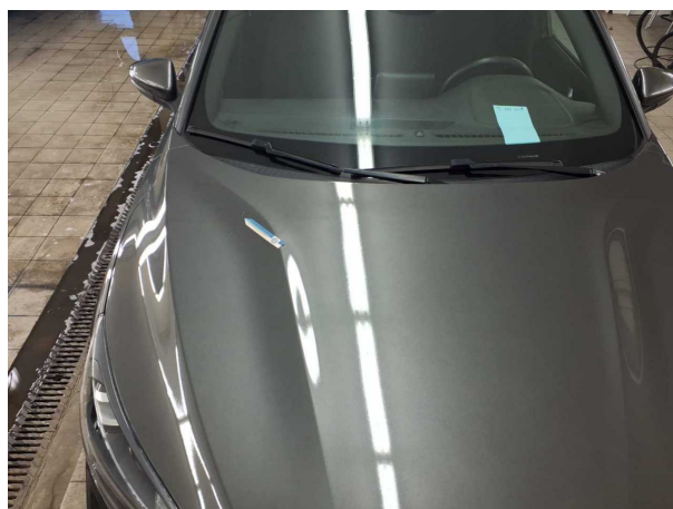
Beschädigung #6: Motorhaube: Motorhaube (Dellen) - Kratzer
