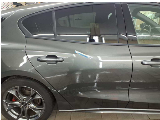
Beschädigung #13: Tür hinten rechts: Tür - Delle / Lackschaden
