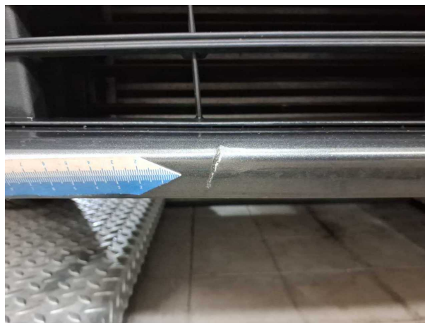
Beschädigung #12: Stossfänger vorn: Stossfänger vorn - Kratzer
