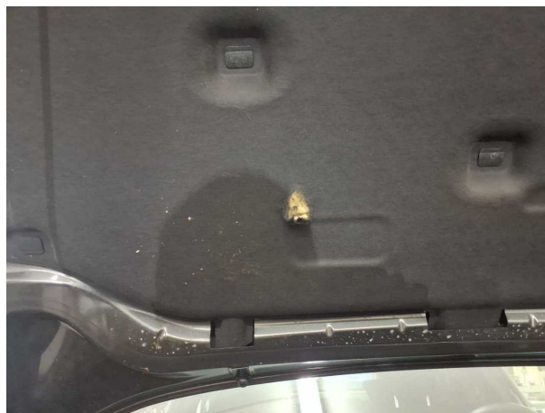
Beschädigung #7: Motorhaube: Dämmmatte - gebrochen / gerissen
