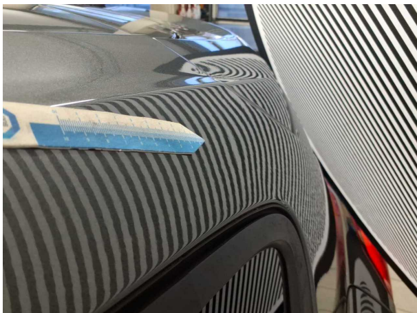
Beschädigung #10: Seitenwand links: Seitenwand (3 Dellen) - Delle(n)
