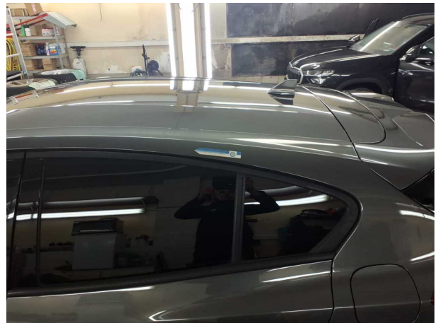
Beschädigung #2: Fahrzeugdach: Dachholm links - Delle(n)
