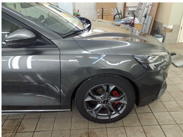
Beschädigung #5: Kotflügel rechts: Kotflügel rechts - verformt
