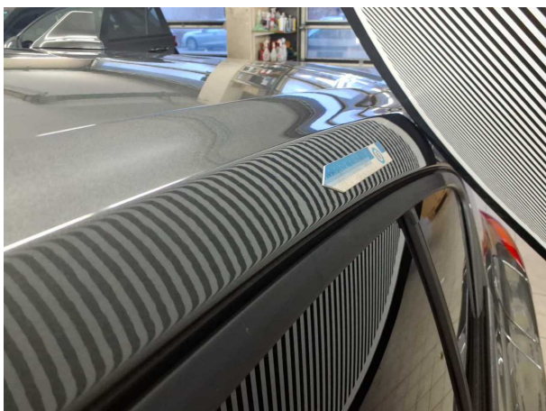
Beschädigung #2: Fahrzeugdach: Dachholm links - Delle(n)
