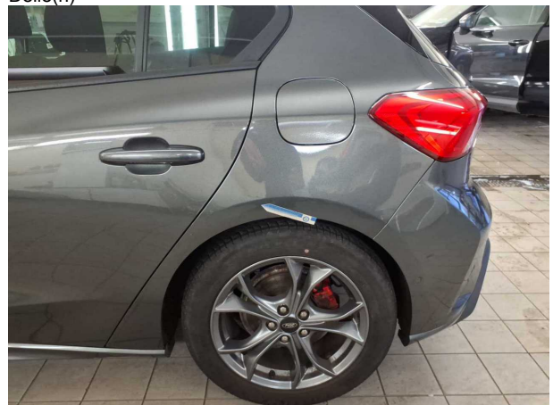
Beschädigung #10: Seitenwand links: Seitenwand (3 Dellen) - Delle(n)
