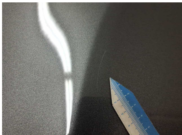
Beschädigung #6: Motorhaube: Motorhaube (Dellen) - Kratzer
