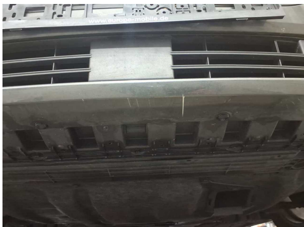
Beschädigung #12: Stossfänger vorn: Stossfänger vorn - Kratzer
