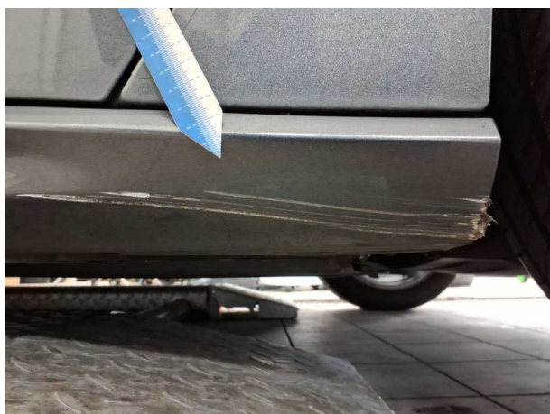
Beschädigung #8: Schweller links: Schweller - verformt
