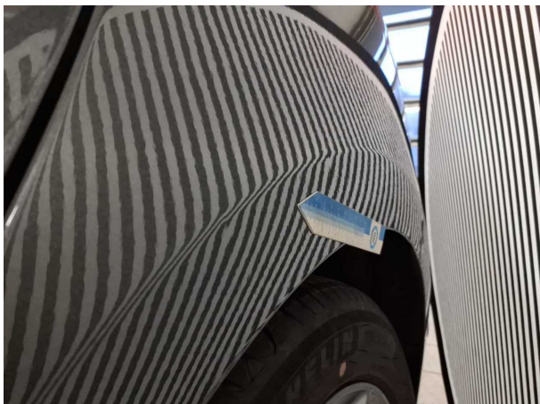
Beschädigung #10: Seitenwand links: Seitenwand (3 Dellen) - Delle(n)
