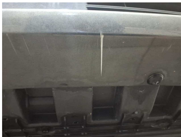
Beschädigung #12: Stossfänger vorn: Stossfänger vorn - Kratzer
