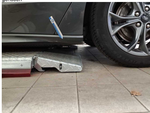
Beschädigung #8: Schweller links: Schweller - verformt
