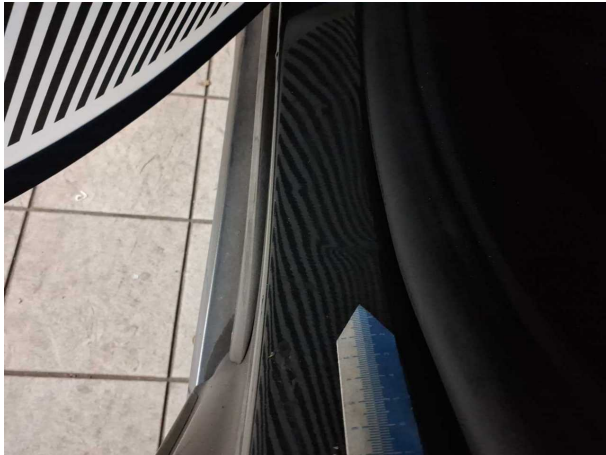
Beschädigung #9: Seitenwand links: Einstieg (3 Dellen) - Delle(n)
