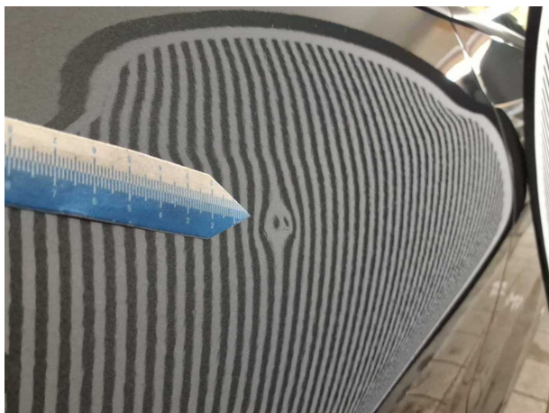
Beschädigung #13: Tür hinten rechts: Tür - Delle / Lackschaden
