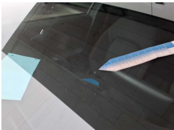
Beschädigung #15: Verglasung: Frontscheibe - Steinschlag
