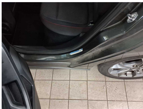
Beschädigung #9: Seitenwand links: Einstieg (3 Dellen) - Delle(n)
