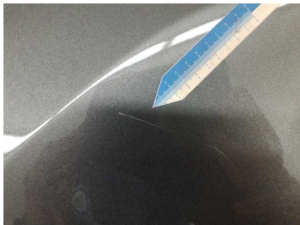
Beschädigung #6: Motorhaube: Motorhaube (Dellen) - Kratzer
