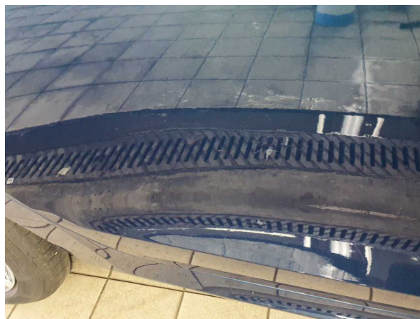
Beschädigung #8: Tür hinten rechts: Tür - Kratzer
