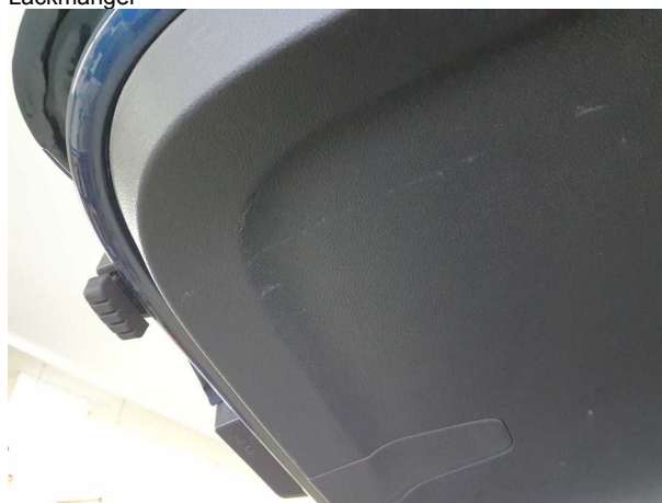
Beschädigung #11: Verkleidungen/Abdeckungen: Heckdeckel, Innenverkleidung - Kratzer
