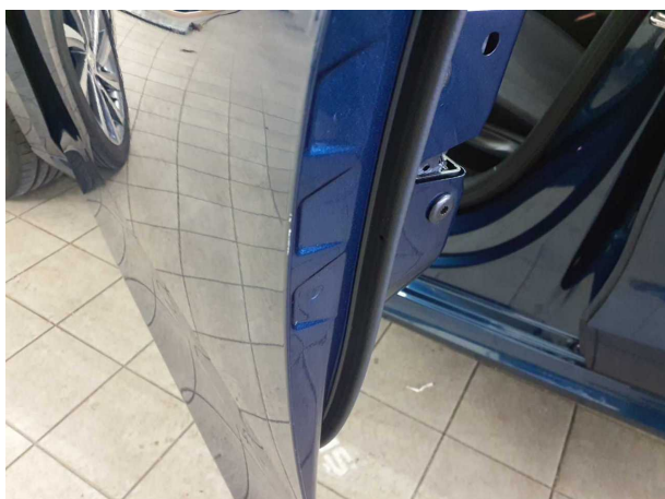
Beschädigung #9: Tür vorn links: Tür (Türkante) - Kratzer
