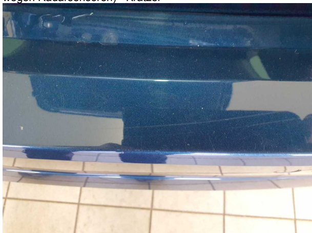
Beschädigung #6: Stossfänger hinten: Stossfänger hinten (Erneuern wegen Radarsensoren) - Kratzer
