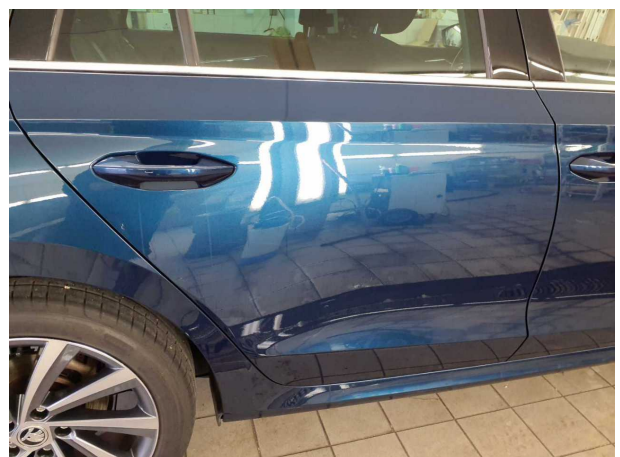
Beschädigung #8: Tür hinten rechts: Tür - Kratzer
