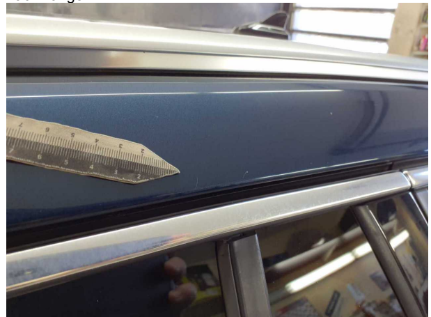
Beschädigung #2: Fahrzeugdach: Dachholm links - Funktion / Zulässigkeit
