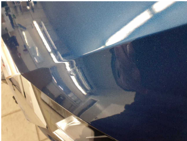
Beschädigung #4: Motorhaube: Motorhaube (Harzflecken) - Lackmangel
