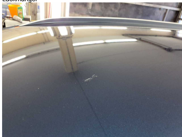
Beschädigung #1: Fahrzeugdach: Dach (Harzflecken) - Lackmangel
