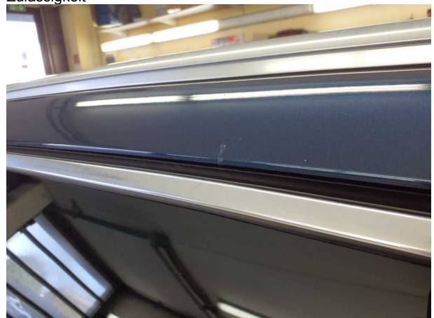
Beschädigung #3: Fahrzeugdach: Dachholm rechts (Harzflecken) - Lackmangel
