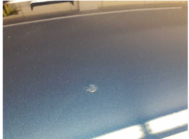
Beschädigung #1: Fahrzeugdach: Dach (Harzflecken) - Lackmangel
