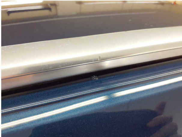
Beschädigung #1: Fahrzeugdach: Dach (Harzflecken) - Lackmangel
