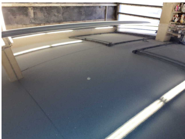
Beschädigung #1: Fahrzeugdach: Dach (Harzflecken) - Lackmangel
