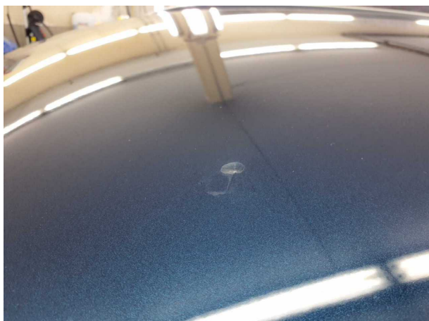
Beschädigung #1: Fahrzeugdach: Dach (Harzflecken) - Lackmangel
