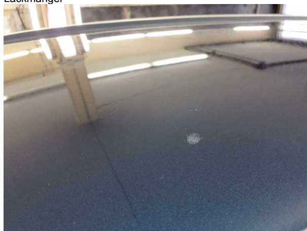
Beschädigung #1: Fahrzeugdach: Dach (Harzflecken) - Lackmangel
