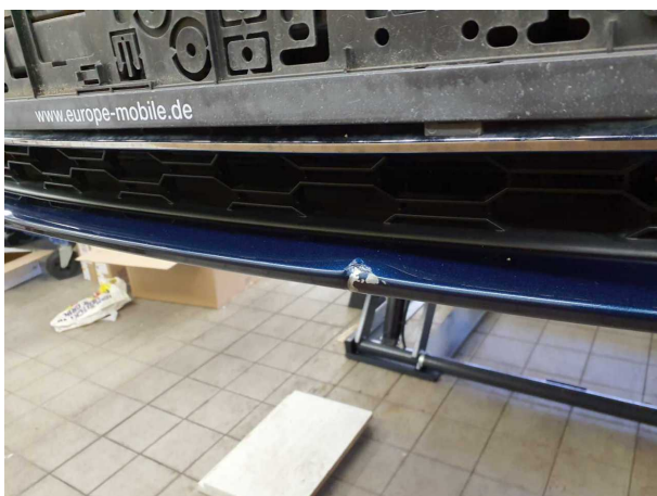
Beschädigung #7: Stossfänger vorn: Stossfänger vorn - verformt
