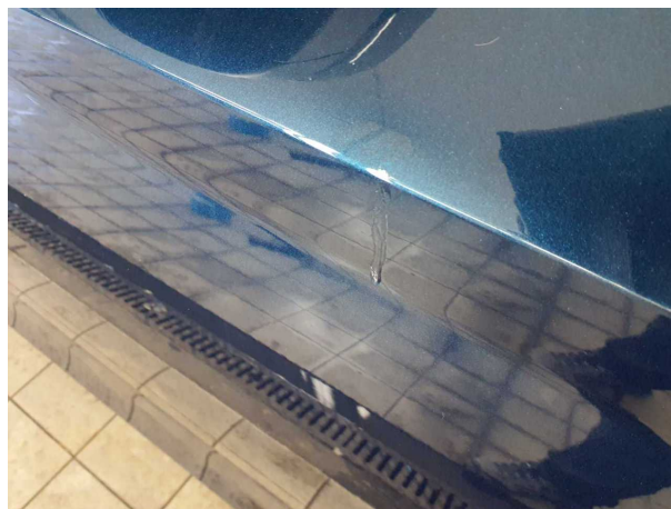
Beschädigung #10: Tür vorn rechts: Tür (Harzflecken) - Lackmangel
