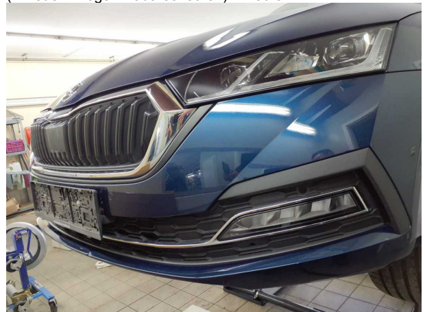
Beschädigung #7: Stossfänger vorn: Stossfänger vorn - verformt
