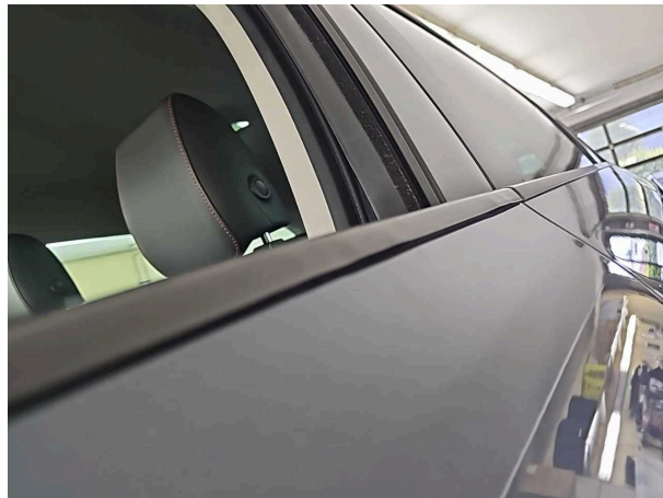
Beschädigung #1: Tür vorn links: Schachtleiste außen - verformt
