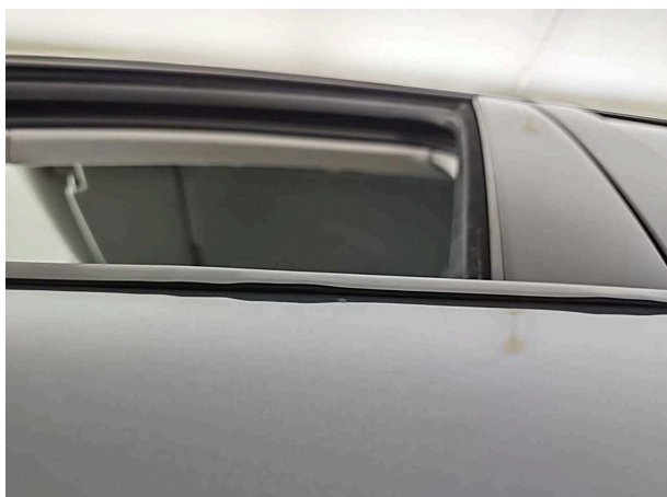
Beschädigung #1: Tür vorn links: Schachtleiste außen - verformt
