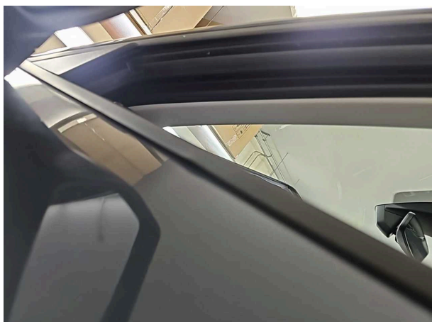
Beschädigung #1: Tür vorn links: Schachtleiste außen - verformt
