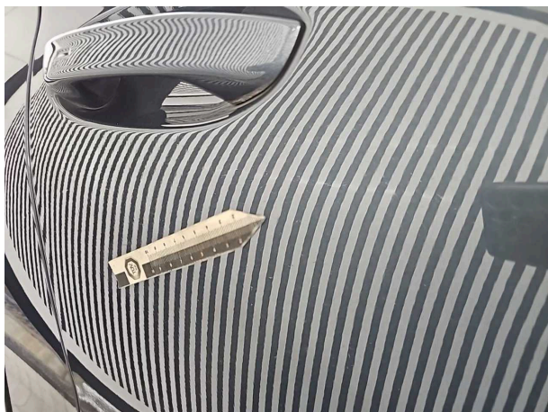
Beschädigung #2: Tür vorn rechts: Tür - Delle(n)
