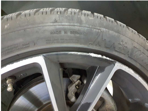
Beschädigung #6: Rad/Reifen: Leichtmetallfelge vorn rechts - Kratzer
