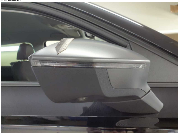
Beschädigung #2: Außenspiegel rechts: Abdeckkappe - Kratzer
