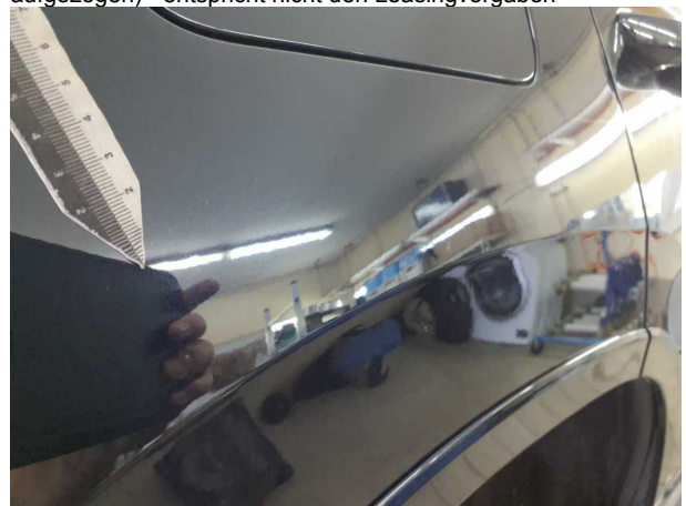
Beschädigung #8: Seitenwand rechts: Seitenwand - Delle / Lackschaden
