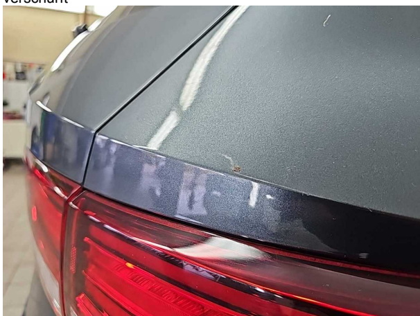
Beschädigung #2: Seitenwand rechts: Seitenwand - verkratzt / verschürft
